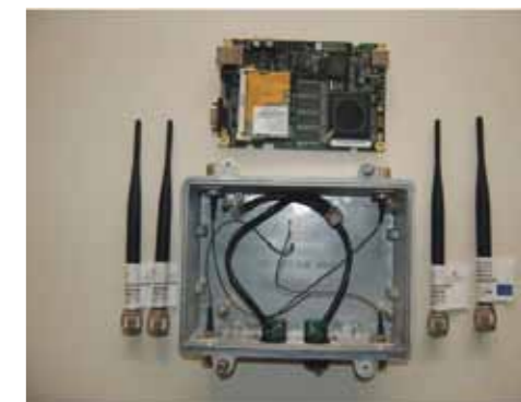
Prototipo di nodo per reti Mesh Wi-Fi "enhanced" sviluppato presso il laboratorio ARTS
