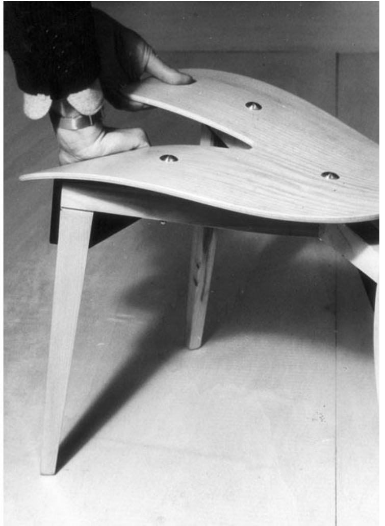
Sedia in compensato curvato di frassino lucidato naturale, con schienale elastico su cuscinetti di gomma e sedile elastico; giunti rinforzati senza colla.
